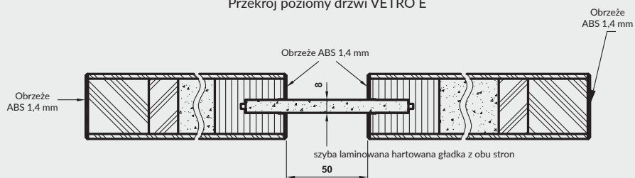
Przekrój poziomy drzwi VETRO E
