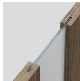
łączenie z szybą „na kant” skrzydło bezprzylgowe
