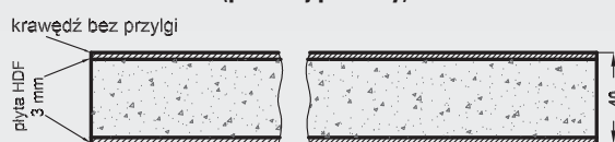
Drzwi przesuwne z wypełnieniem (przekrój poziomy)
